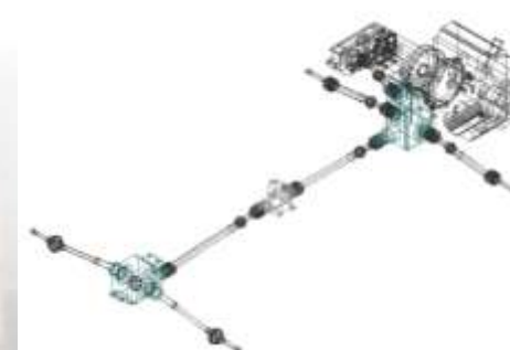
图：自主设计发动机后置四轮驱动系统
