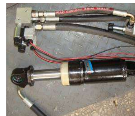
图：油气悬架液压缸及其液压管路
