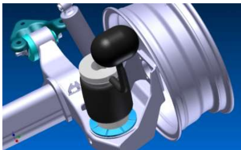
图：空气悬架虚拟样机辅助设计
